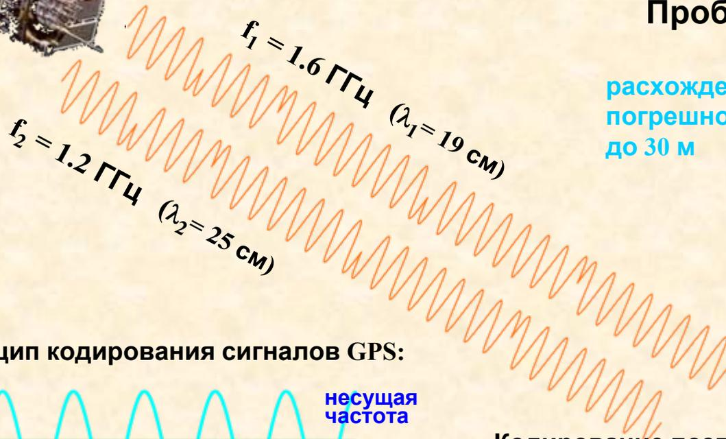
Определение координат в GNSS основано на точном измерении времени распространения сигнала от ИСЗ до приемника
